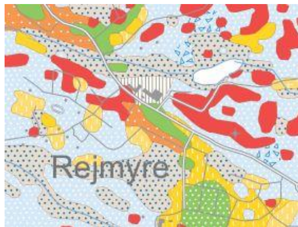
Figur 3. Utdrag av SGU:s jordartskarta 1:25 000 (grön=isälvssediment, röd=urberg, ljusblå=sandig morän, beige med blå prickar=kärrtorv, lodräta sträck runt glasbruket=fyllning). © Sveriges geologiska undersökning (SGU). Topografiskt underlag © Lantmäteriet.
